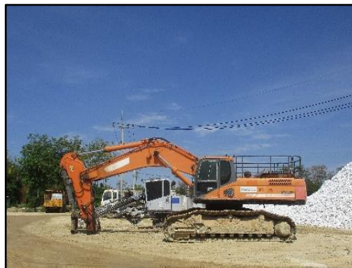
ภาพที่ 2.5 การนำ Hydraulic Breaker ติดรถ Back Hoe ใช้ในการทำเหมือง
